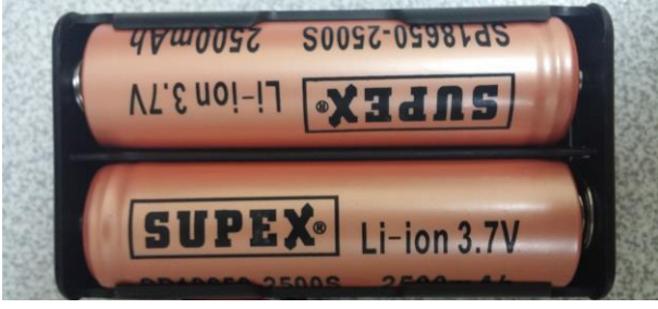
Şekil 7 : Robot için toplam 10 adet li-ion pil kullanılmıştır. SUPEX marka 3.7V 2500mAh lik piller 2şerli gruplar halinde kullanılarak gerekli beslemeler sisteme verilmiştir.
